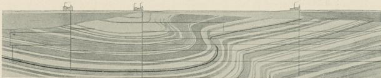
Flözprofil des Wilhelm-, Hermenegild- und Jakob-Schachtes in Polnisch-Ostrau.
