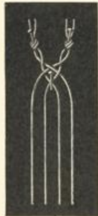
Abb. 12. Das Einstecken der Nadel in der Mitte des Ganzschlages.
