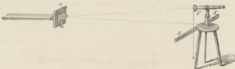
trieb mit galvanischen Strömen, sondern in der Form, welche er 1835 zum Telegraphiren mittels Magneto-Inductionsströmen erhalten hatte. Die Nadel in seinem Zeichenempfänger ist ein riesiger Magnetstab von 1,21 Meter Länge, 0,075 Meter Breite und 0,015 Meter Dicke; die ihn
