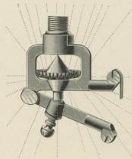
Sprinkler in Thätigkeit.
