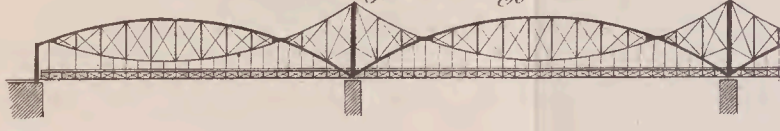
System Ruppert Projekt einer Donaubrücke bei Wien (Strombrücke 3 Öffg. à 230 und 2 Öffg. à 240 Fuss Ø)
